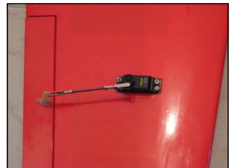
Ich habe für die Anlenkung 3mm Gewindestangen benutzt, wie immer.
