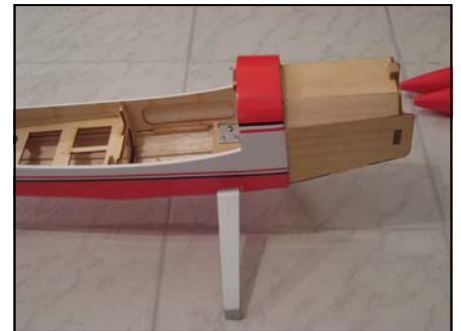
Hier sind die Beine des Fahrwerks bereits eingebaut und verschraubt.
