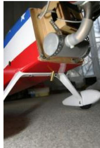
Als Tank wurde ein 500ml (benzinfest) angeschafft und im vorderen Teil des Rumpfes untergebracht. Zwecks Komfort beim Betanken wurde ebenso ein Schnelltankventil in die Rumpfsseitenwand verbaut. Der Überlauf schaut mit einem Teil des Beschlages aus der Rumpfunterseite heraus. Die Anlenkung des Vergaser wurde mittels 3mm Gewindestange und herkömmlichen Gabelköpfen realisiert. Als Propeller wurde ein 18/8 gewählt, lt. verschiedenen Empfehlungen.
