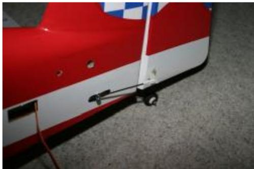
Jetzt werden alle Löcher im Rumpf, die man zum Fertigstellen braucht, mit einem scharfen Messer geöffnet, ebenso die Einbaustellen für die Höhenruderservos und des Seitenruderservos. Alles passt und sitzt so weit perfekt, dass nicht nachgearbeitet werden muss. Will man das Seitenruderservo auch am Heck im Rumpf verbauen, muss man dazu die Rumpfunterseite öffnen (Balsabrettchen rauschneiden), und anschließen wieder mit dem rausgeschnittenen Teil verschrauben.
