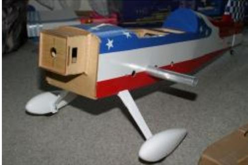
Zusammenbau des Hauptfahrwerkes, welches ebenfalls sehr stabil erscheint, Montage der Radhauben und Einbau der Räder. Das Hauptfahrwerk wird mit 4 M4 Imbusschrauben am Rumpf befestigt (Einschlagmuttern an der Rumpfinnenseite). Wie in der Einleitung schon erwähnt besteht die Aufnahme des Fahrwerks aus einem Sandwich von Sperrholz, Alu und wieder Sperrholz.
