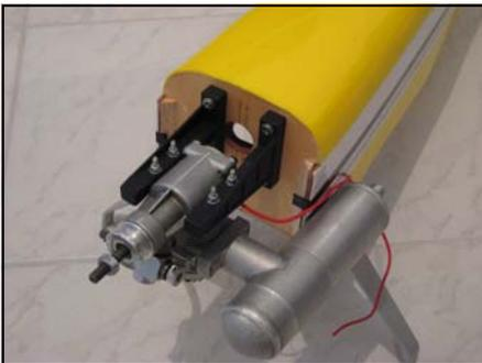
*Der Motor ist hängend eingebaut und verschwindet fast zur Gänze unter der Haube.*
